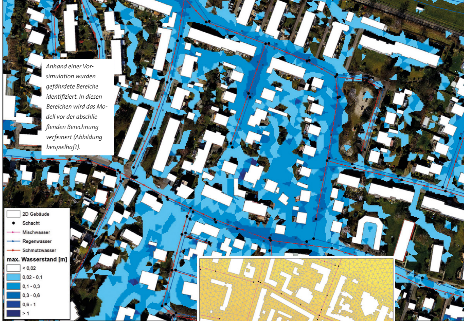
Aus digitalem Geländemodell und Elementen wie Gebäudeumrisse wird ein unregelmäßiges Dreiecksgitter für die Berechnung des Oberflächenabflusses erzeugt
